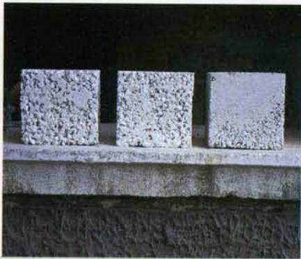
**4. Il cantiere** di recupero bioecologico si fonda sulla sperimentazione: provini di cemento bianco, misto a sughero in granuli, da impiegare quale materiale leggero di riempimento dell'intradosso di una volta da consolidare
